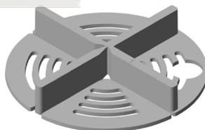
Die Verwendung von Abstandhaltern ist grundsätzlich beim Einbau unserer Plattenbeläge empfehlenswert. Abstandhalter eignen sich insbesondere bei der losen Verlegung von Plattenbelägen (klassische Verlegung auf einer Splitt-Feinplanie). Materialien wie beispielsweise Feinsteinzeug setzen den Einsatz von Abstandhaltern zwingend voraus.
