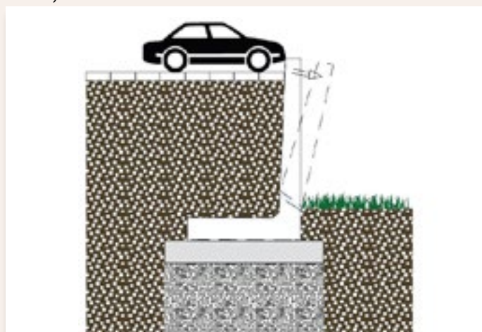
Winkelplatte duplex kippt aufgrund zu geringer Auflast.
