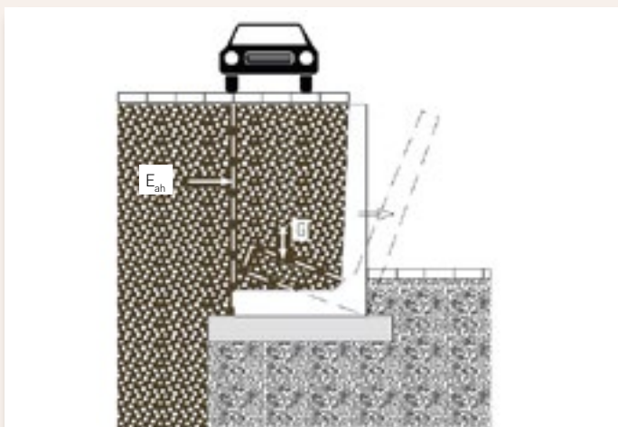
Winkelplatte duplex kippt aufgrund zu geringer Auflast.
