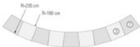
Radius bei Verwendung eines Radiensteins und eines Halb-Elementes im Wechsel
