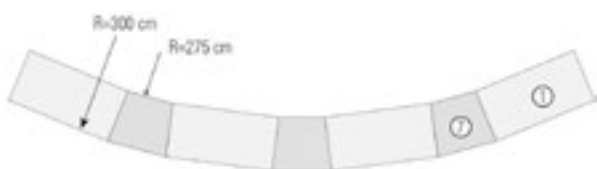
Radius bei Verwendung eines Radiensteins und eines Grundelementes im Wechsel
