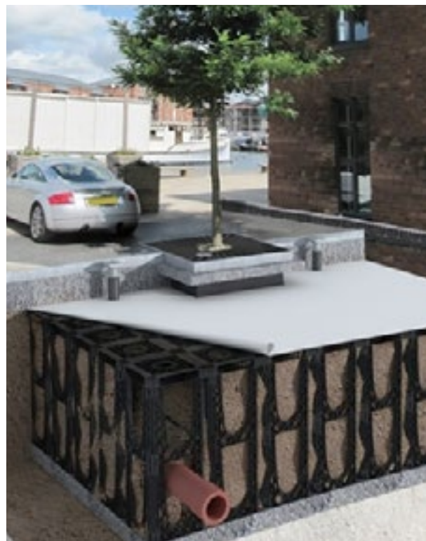
Das Greenleaf® Rootspace Wurzelkammersystem ist bis 26 Tonnen pro m 2 belastbar und somit auch für den Baumstandort im Strassenraum geeignet. Gegen seitlichen Bodendruck bieten die Seitenelemente zusätzliche Stabilität für die Baumstandorte. Die offene Struktur ermöglicht die problemlose Kombination mit Leitungen. Die Abdeckungen können später auch entfernt werden, um den Zugang zu den Leitungen sicherzustellen.
