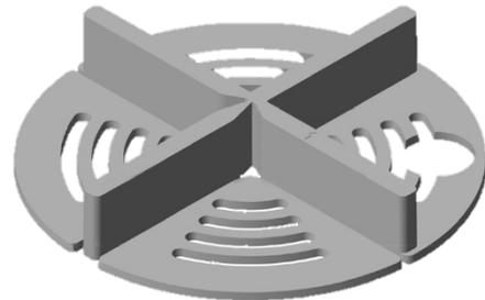
Auch bei der Vermeidung von Ausblühungen bei Verlegearbeiten mit Platten spielen Abstandhalter eine vorteilhafte Rolle. Platten, die mit offenen Fugen verlegt werden, neigen nämlich weniger zu Ausblühungen, da die Feuchtigkeit unter den Platten durch die offenen Fugen besser entweichen kann. Bei geschlossenen Fugen muss die Feuchtigkeit durch die Platten aufsteigen und löst dadurch den Kalk aus den Platten, was zu Ausblühungen führen kann.
